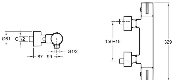
Спецификация продукта: Термостатический настенный смеситель для душа. Е8991. Коллекция: ТООВИ. ВЕС: 2,9 кг. ТИП УСТАНОВКИ: Крепление к стене. ТИП: Термостатический. РАСХОД ВОДЫ: 13 л/мин. ПОДКЛЮЧЕНИЕ: С настенными крепежами и кольцами. МЕХАНИЗМ: Термостатический картридж. РАЗМЕТКА ОТВЕРСТИЙ: 150 ± 15 мм. ЭКОНОМИЧНОЕ ПОТРЕБЛЕНИЕ: Экономия воды и энергии. СЛИВ: 0. ОДНОРЫЧАЖНЫЙ СМЕСИТЕЛЬ: ТЕРМОСТАТИЧЕСКИЙ ОДНОРЫЧАЖНЫЙ СМЕСИТЕЛЬ. УСТАНОВКА: 2 отверстия. ГАРАНТИЯ НА ОТДЕЛКУ: 10 лет.
